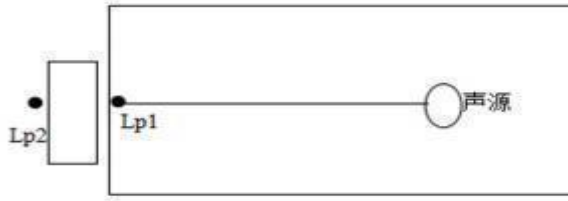
图 4-1 室内声源等效为室外声源图例
